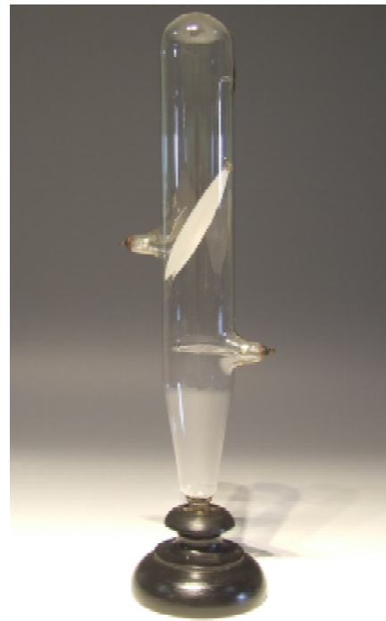
Фосфоресцентна лампа Івана Пулюя
